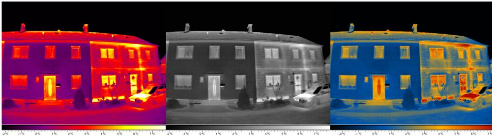
**Bild 1.** Vergleich von diversen Farbpaletten, durch angemessene Kontrastierung ist trotz verschiedener Einfärbung auf allen Thermogrammen das gleiche erkennbar.
